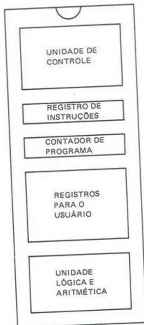
Partes funcionais do chip Z80
