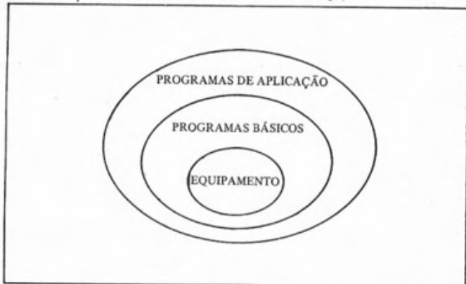
FIGURA 1-3: CAMADAS DE UM SISTEMA DE COMPUTAÇÃO
