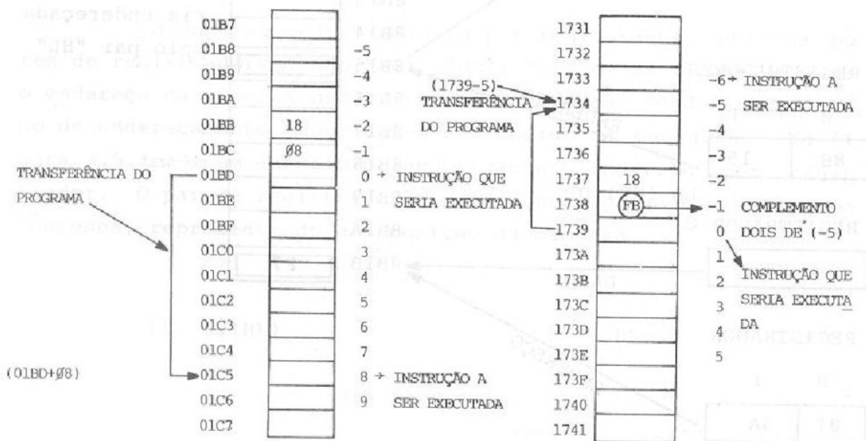
Fig. 4.7 - Fluxo de Dados de Endereçamento Relativo.
