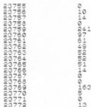
Figura 2.2. Forma como é armazenada na zona de programas a linha: 10 LET A=1443.
