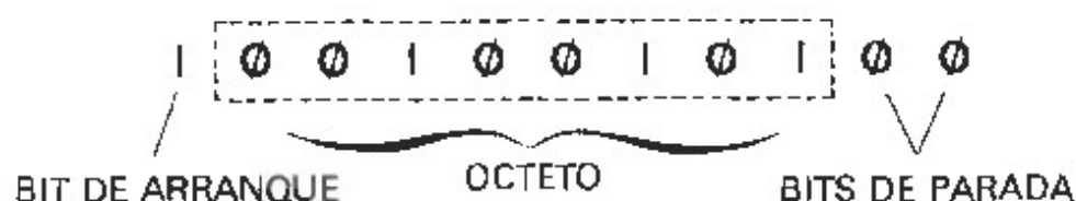
Fig. 7.17. Uso de los bits de «arranque» y de «parada» para la transmisión en serie.
