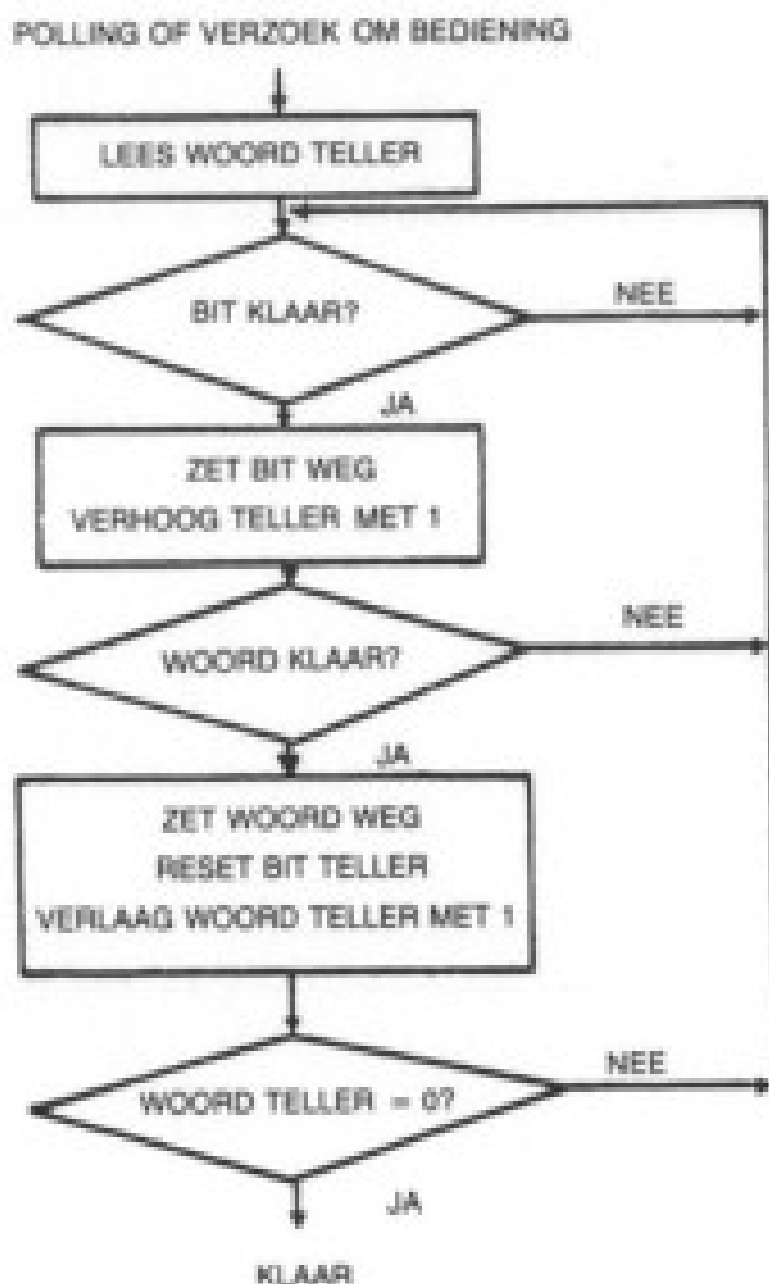
Fig. 6.6: Bit seriële data overdracht. Stroomdiagram.
