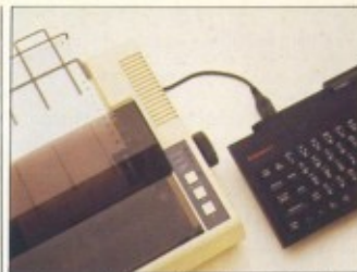
Las impresoras de tipo estándar son conectadas al ordenador mediante el punto de contacto ZX Interface 1.
