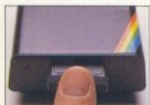
Cargando una Microdrive Los cartuchos Microdrive son insertados en la ranura situada al frente de la Microdrive.
