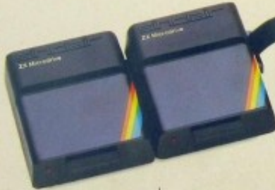
Microdrive birimleri Bir Spectrum'a bu depolama birimlerinden sekiz tane bağlanabilir.
