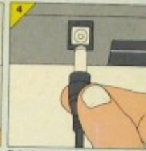
Televizyonunuzun anten kablounu çıkarın. Anten bağlantısındaki diğer fişi de televizyonun anten girişine takın.
