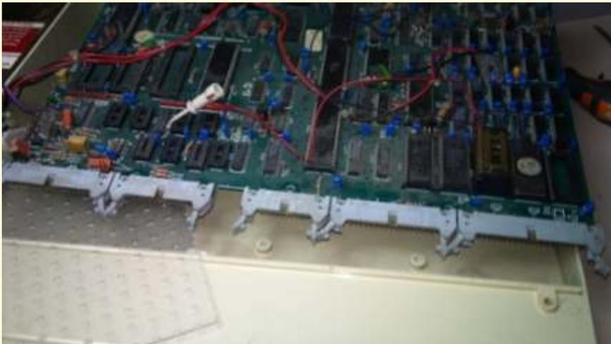
Así sólo tuve que cortar la alimentación a la placa de la imagen de arriba que veis, pelar los cuatro extremos de los cables propios del equipo e introducirlos en los prensa cables. Un apretón, un poco de cinta aislante y listo. Enchufamos la alimentación al DATACENTRE y el cable de led suministrado. Ahora sí vamos a hacer la primera prueba.
