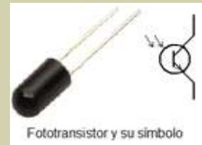
Se usan mucho junto a un LED para detectar si algo interrumpe el haz de luz que genera el diodo, por ejemplo los ratones de bola detectan el giro de la misma moviendo unas ruedas perforadas en su interior, y contando el número de agujeros sabe la velocidad y cantidad del movimiento. Este montaje lo suelen
