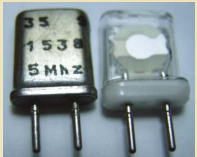
para medir el tiempo, ya que mientras tengan pilas y no varíe la corriente son muy precisos. En nuestros equipos son los que generan los diversos relojes que controlan la sincronización entre los componentes.
