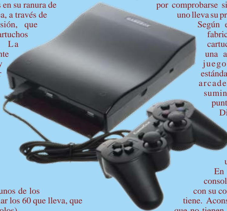
funciones, tan solo la de salida TV y la decodificación de vídeo alta calidad y audio. La velocidad ha sido ajustada a 250 Mhz por núcleo (500 Mhz al total), al menos, eso dice el fabricante). Uno de los núcleos es exclusivo para el tratamiento del vídeo, y el otro, para la ejecución de programas.
