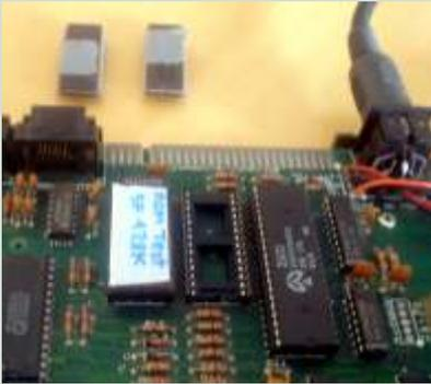
Esta EPROM se enchufa en uno de los zócalos destinados a las ROM's, concretamente, el izquierdo. Para los modelos anteriores de 128K, esta EPROM se pondría lógicamente en lugar de la única ROM que tiene el equipo. Al arrancar de nuevo con la ROM de testeo, obtuve lo siguiente:
