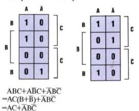
$ABC+AB\overline{C}+\overline{A}BC+\overline{A}BC$  $=AB(C+\overline{C})+\overline{A}C(B+\overline{B})$  $=AB+\overline{A}C$
