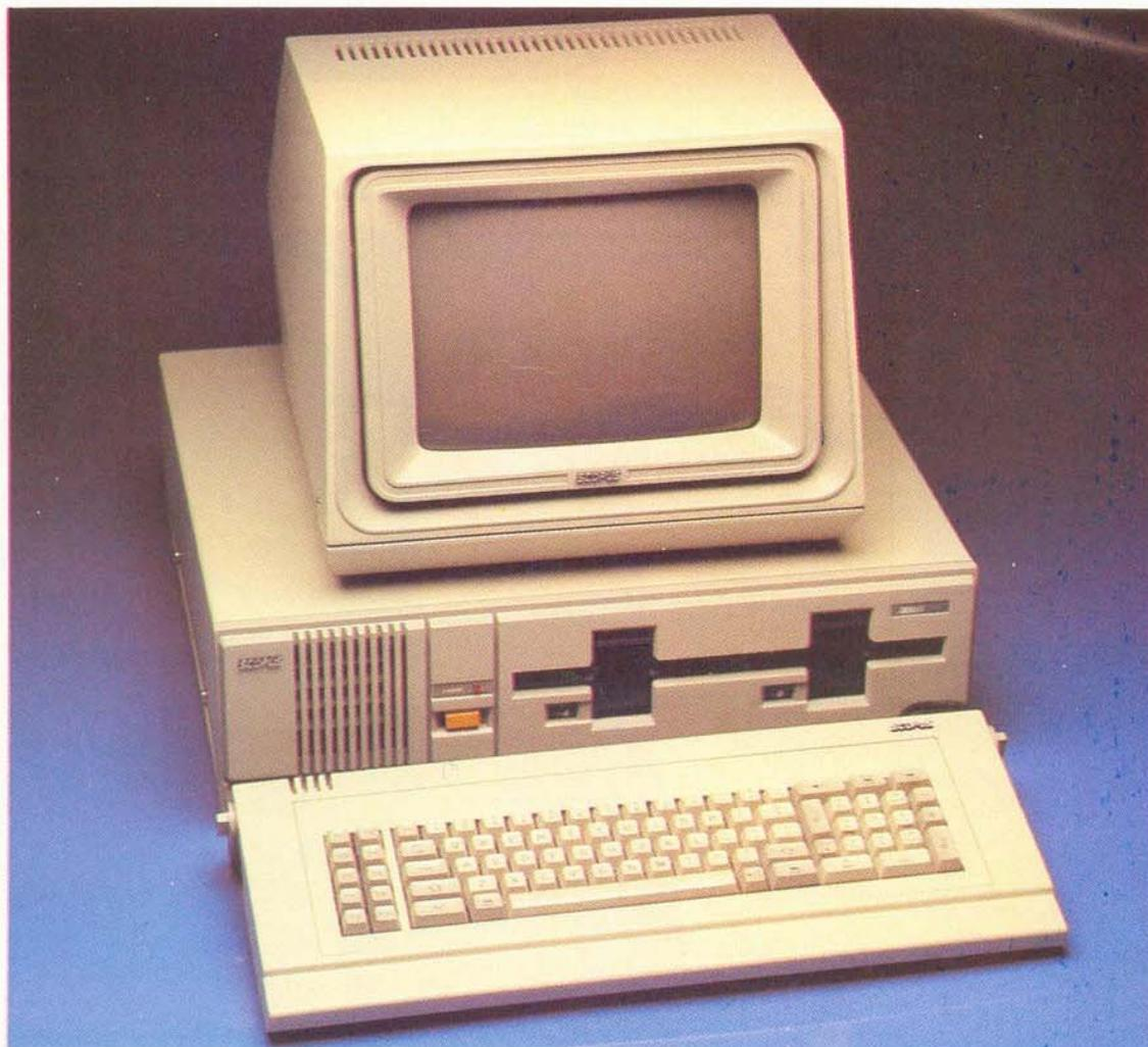
As características ergonômicas do Nexus 1600, desenvolvidas pela Scopus, permitem uma melhor adaptação do operador à máquina. O vídeo basculante com tela anti-reflexo, o teclado leve e de inclinação variável, o cabo espiralado que liga o teclado à unidade de sistema são importantes requisitos que visam sobretudo o conforto e produtividade do usuário.
