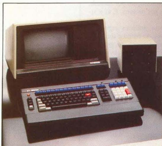
Assim, o SID 3300 tem uma unidade DUAL de discos flexíveis de 5 1/4 polegadas e interface de comunicação RS232 C. O SID 3801 aceita até duas unidades DUAL de discos flexíveis face simples de 8 polegadas, com duas interfaces de comunicação RS232 C e RS422. O SID 3802, com as mesmas características de seus irmãos de série, tem ainda a vantagem de aceitar discos flexíveis face dupla de 8 polegadas.
