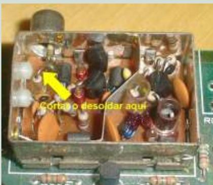
En nuestro caso se pide una salida separada de video compuesto, sin “mutilar” la existente de RF, así que hay que instalar un nuevo conector RCA hembra en una localización en la que no “choque” con otros componentes al juntar las
