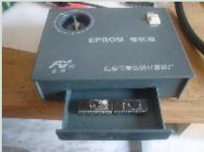
El borrador tiene un temporizador dividido en tramos de 5 minutos. Con el selector en la posición indicada, el tiempo de borrado será de unos 20-25 minutos.
