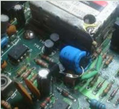
Si se quiere reutilizar la salida de RF como salida de video, basta llevar con un cable la señal de video desde el extremo positivo del condensador, hasta la toma central RCA que hay dentro del modulador. Previamente se habrá cortado o desoldado el componente que va conectado a dicha toma central tal como indica la siguiente figura.
