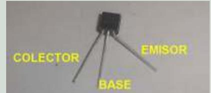
Los pins COLECTOR y BASE se sueldan en los puntos indicados. El pin EMISOR se deja "al aire".
