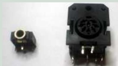
Se quita el otro conector estéreo que estaba puesto, y se limpia con malla de desoldar los pads de ambos conectores. Tras esto sólo hay que volver a soldar cada conector en su sitio.
