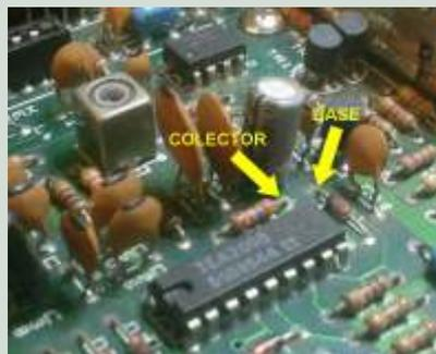
El transistor se prepara de la siguiente forma: se separa el pin EMISOR de los otros dos. A los
