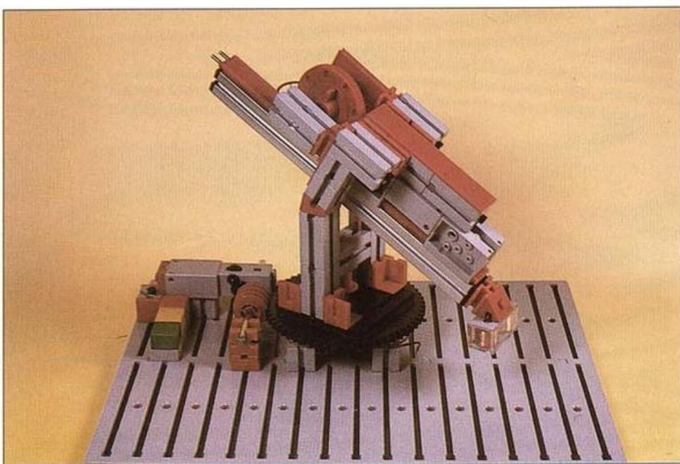
como eje de giro engranando con un tornillo sin fin, acoplado al primer motor mediante la caja reductora correspondiente. En el centro de la rueda y utilizando su mismo eje de giro, se ha dispuesto un potenciómetro, que gira solidariamente con el brazo. La medición de un potencial eléctrico entre sus terminales sirve para conocer la posición absoluta y por tanto se puede establecer un mecanismo de realimentación (*feedback*) con el motor para ob-
