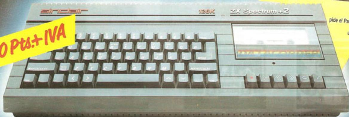
Microprocesador Z80A. 128 K RAM. 32 K ROM. Teclado de 58 teclas. 32 columnas X 24 filas de texto. Gráficos de alta resolución (256 X 192 pixels). 8 colores con dos niveles de brillo cada uno. Calculadora en pantalla. 3 canales de sonido programables e independientes. Cassette incorporada. Salida TV y monitor RGB.
