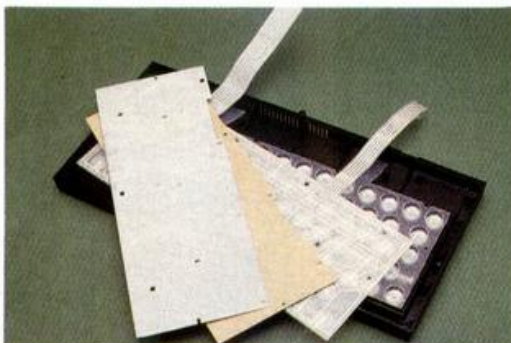
Las cuatro capas que constituyen el teclado.
