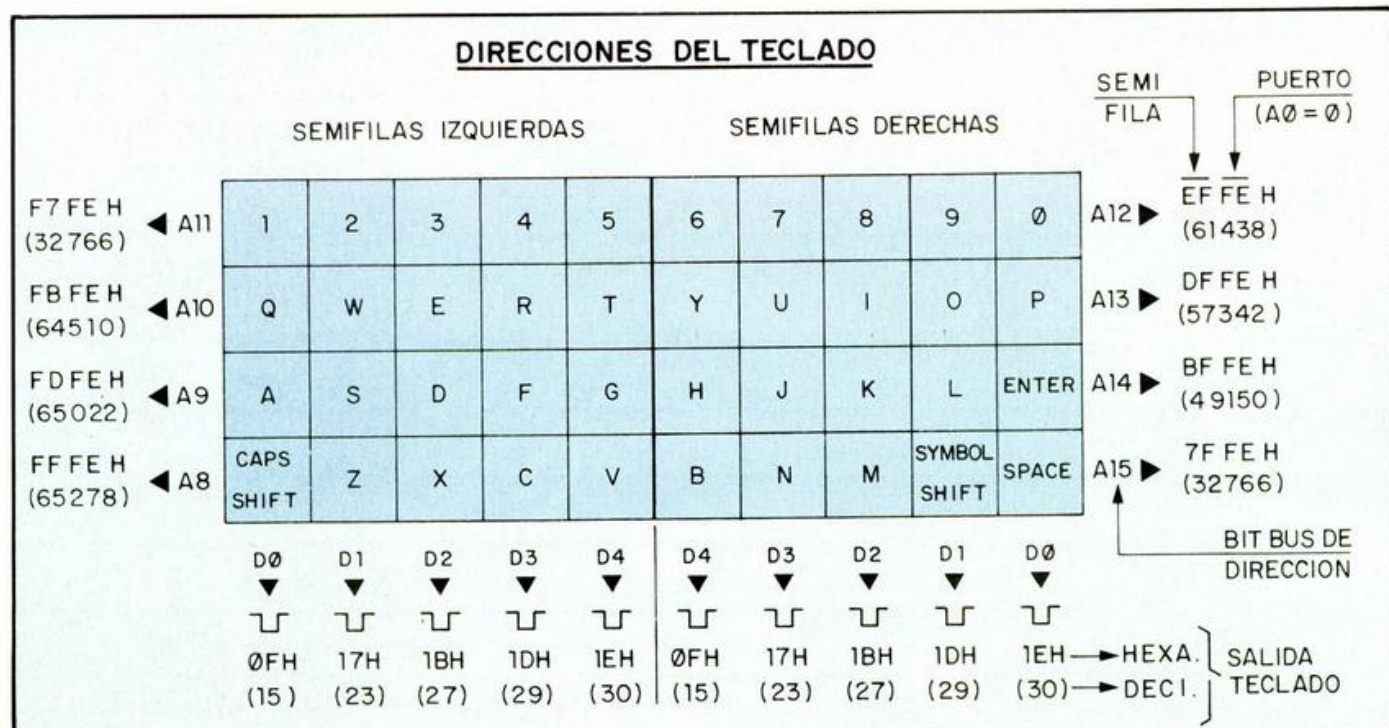
El teclado: Direcciones de sus semifilas y salidas de sus columnas hacia el bus de datos. (Fig. 4).
