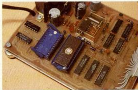
Las EPROM se insertan con suma facilidad. Préstese atención a su orientación según la muesca.
