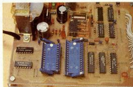
Detalle de la colocación de los zócalos de inserción nula.
