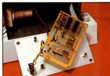
El conmutador ha de ir alambrado a la placa de circuito impreso en el mismo orden que muestran las perforaciones.
