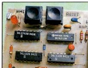
Detalle de los pulsadores NMI y RESET.
