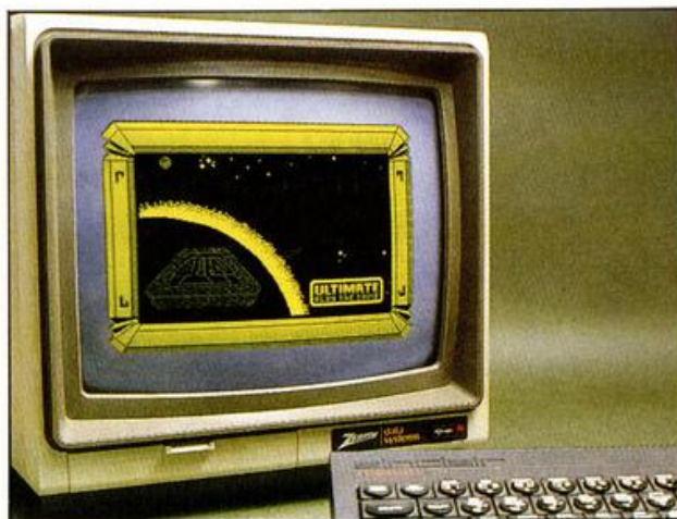
El Spectrum y el monitor de video quedan perfectamente acoplados mediante el amplificador de video.
