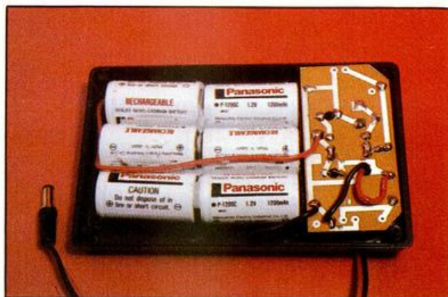
En el interior se observa la disposición de las 6 baterías y el regulador de tensión.
