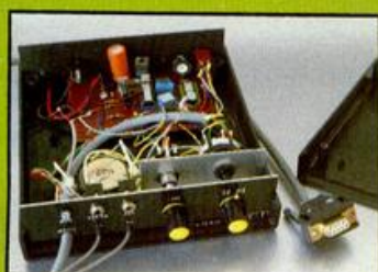
Interface de TYT para «RTTY» y Morse.
