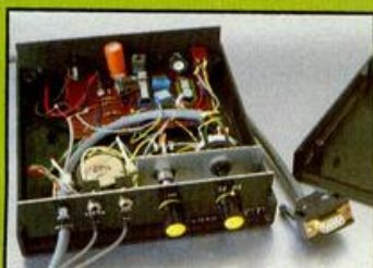
Interface de TYT para «RTTY» y Morse.
