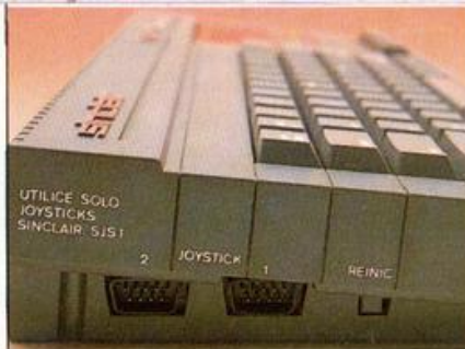
Conectores para JOYSTICK y RESET.
