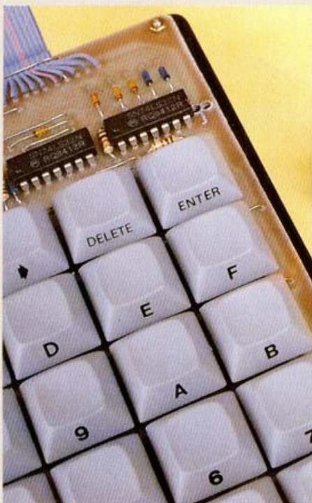
Las inscripciones de las teclas, en el lateral delantero, identifican cada una de ellas sin que se borren sus caracteres.
