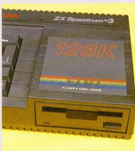
El nuevo Spectrum +3 utiliza discos de 3" con una capacidad de 173K por cada cara.
