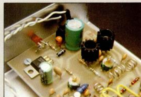
Detalle de los disipadores en los transistores del oscilador de VHF. Los condensadores de ajuste y las bobinas en primer plano.
