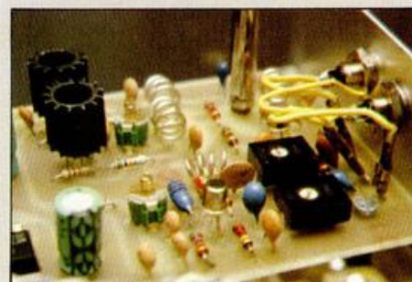
Detalle de los dos potenciómetros de ajuste de profundidad de modulación y nivel de sonido.
