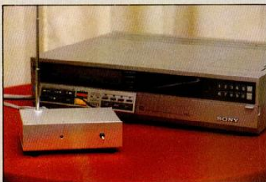
El videoemisor usado para emitir la señal de un videograbador doméstico.
