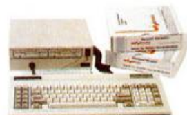
CPU con 2 unidades de diskette 3 1/2" (2 x 720 Kb). Con teclado y sistema operativo MS-DOS 3.2 y GW BASIC 3.2.
