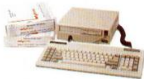
CPU con una unidad de diskette 3 1/2" (720 Kb). Con teclado y sistema operativo MS-DOS 3.2 y GW BASIC 3.2.
