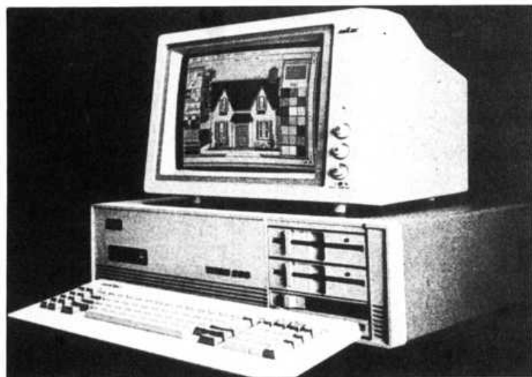
Mitac PC 160T "Turbo", el computador de gran velocidad compatible con IBM PC/XT.
