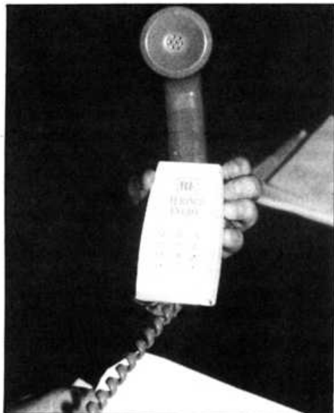
"Generador de Tono", auricular que transmite en tonos el servicio solicitado por el cliente en el sistema del Banco en Casa.
