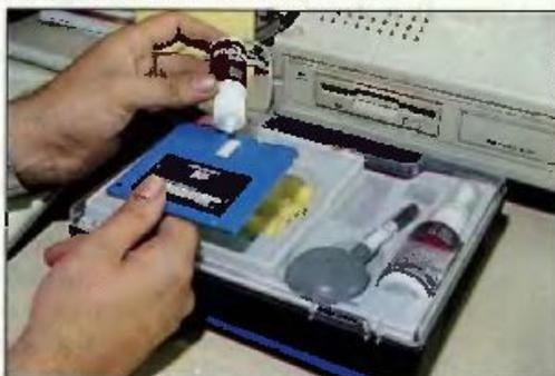
*El disco-limpiador se rocia con la solución no abrasiva que permite limpiar las cabezas sin desgastarlas.*
