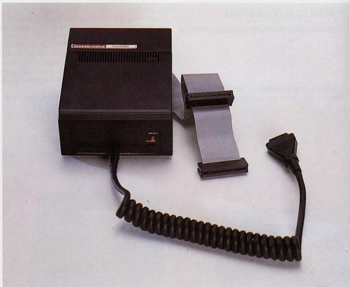
El CONTROLADOR posee su propio microprocesador Z-80 para tratar los datos procedentes del ordenador.
