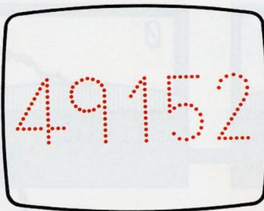
La pantalla se compone de un total de 49.152 elementos de imagen (pixels).
