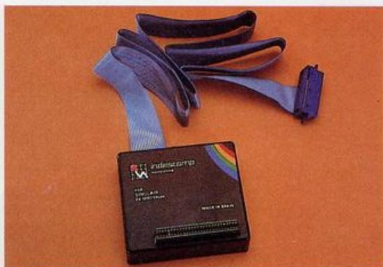
Para las pruebas efectuadas, así como el programa de la próxima sección, se ha empleado un interface Centronics de la firma Indescomp.
