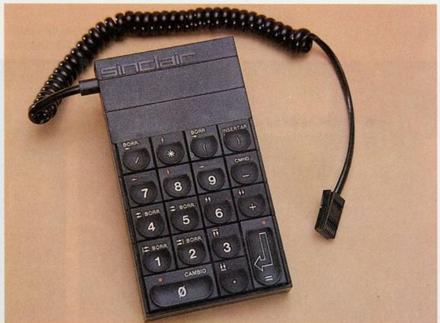
El teclado auxiliar facilita la edición de programas y el control del procesador de textos.
