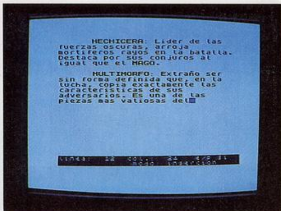
Las dos líneas inferiores del procesador de textos incorporado en el sistema nos informa sobre línea y columna actuales, así como, del modo de escritura implícito.
