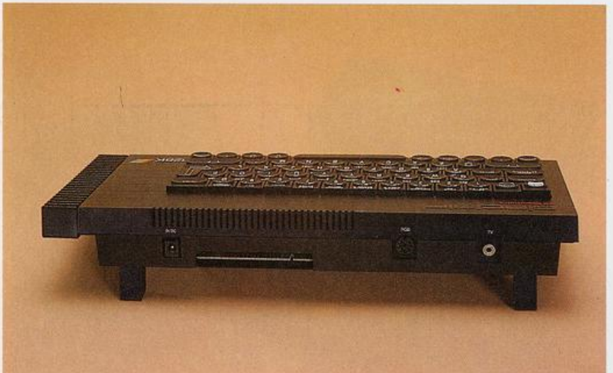
Una toma RGB ha sido habilitada para la conexión directa de un monitor en color.
