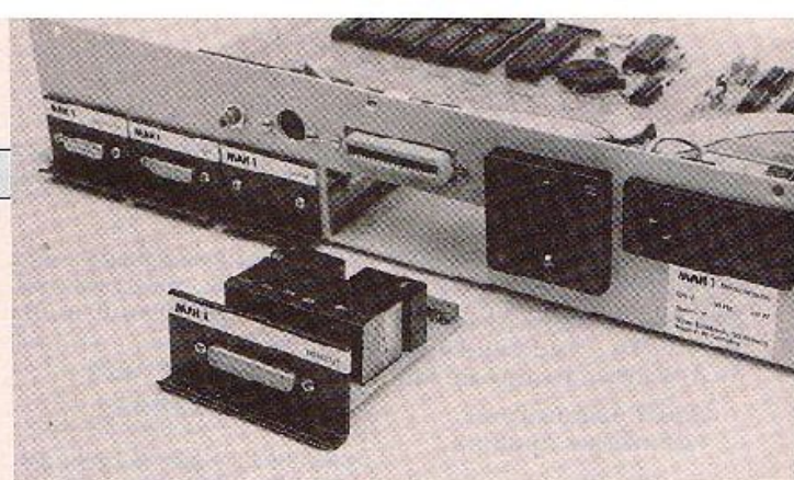
Bild 1. Eine Netzsteckdose für Schaltuhrbetrieb ist eingebaut
