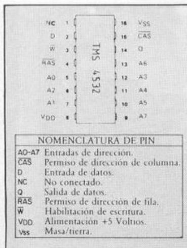
Descripción de patillaje de los integrados de la RAM.
