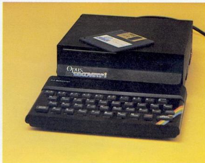
La unidad de disco asoma por encima del ordenador. Los discos son de simple cara/simple densidad.
