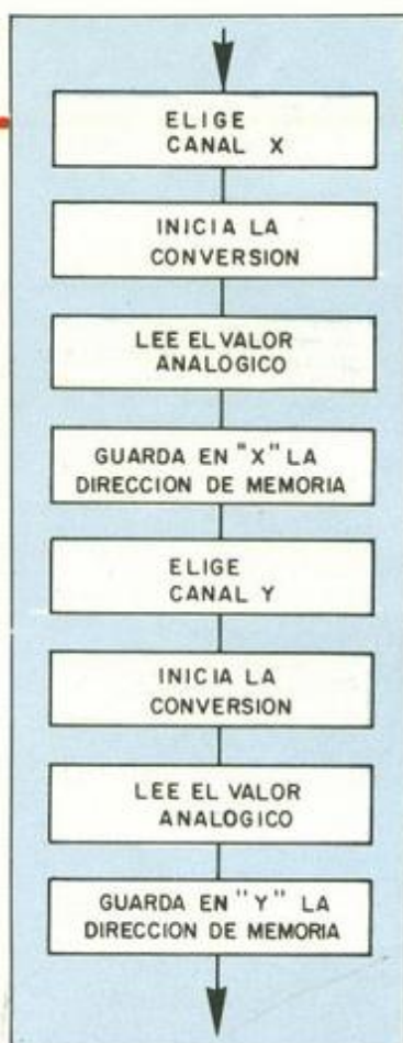
Figura 7. Organigrama de un joystick analógico.
