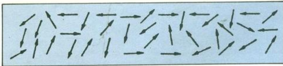
Figura 1. Estado desordenado de los dominios magnéticos en una cinta desmagnetizada.
