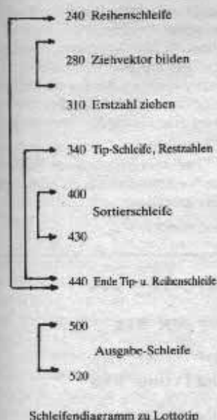
Schleifendiagramm zu Lottotip
