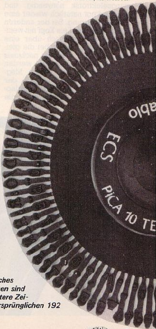
Bild 3. Typenrad-Druckkopf. Jede Speiche hat am oberen Ende eine Zeichentype, die beim Auftreffen des Hammers auf die Speiche gegen das Farbband schlägt.
