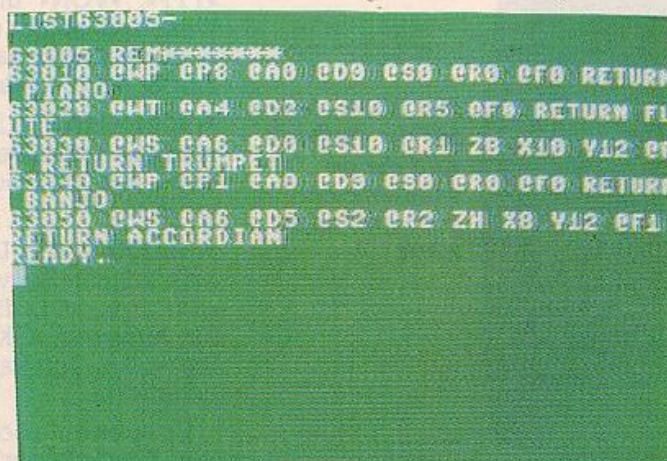
Bild 3. Nützlich bei der Fehlersuche: Die »Trace-Funktion« zeigt jeweils einen Step der Komposition in allen seinen Parametern
