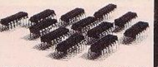
SPECTRUM-AUFRÜSTSATZ Durch Einsetzen von 12 IC's rüsten Sie Ihren 16K auf 48K um. Bitte bei Best. ISSUE TWO oder THREE angeben. Steht auf der Patrone rechts unten! Nr. 111 DM 98,-
