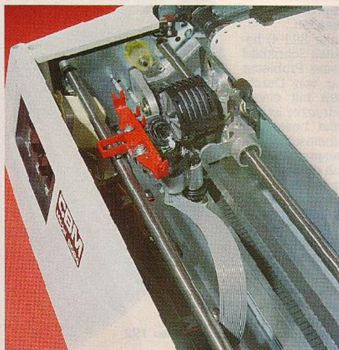
Bild 6. Der Matrixdruckkopf wird auf der Transportschiene mittels des Transportbandes hin und her bewegt
