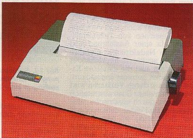
Bild 13. Ein Beispiel für einen Thermodrucker ist der »Silent Type« von Apple
