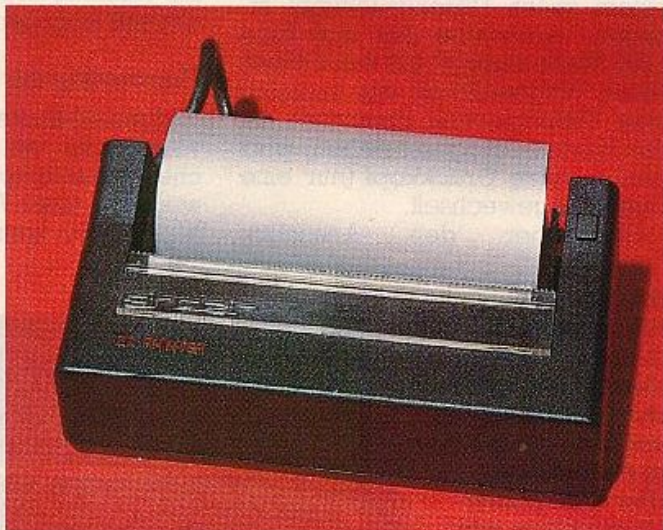
Bild 14. Sinclair benützt als Ausgabegerät für den ZX81 oder Spectrum einen Metallpa- pierdrucker
