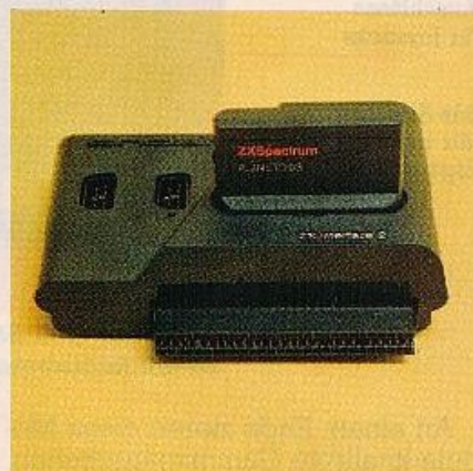
Das Interface ist so klein wie eine Zigarettenschachtel. Hier mit eingestecktem Modul.
