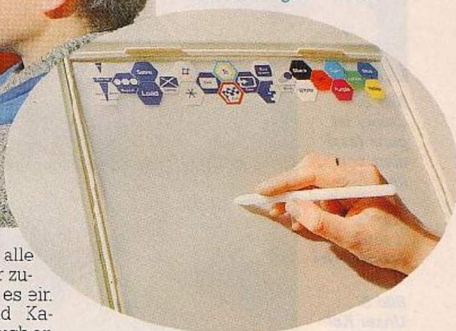
Bild 3. Mit 21 Symbolen auf der Overlay-Folie kann man das Malprogramm bedienen und das PowerPad als Zeichengerät nutzen
