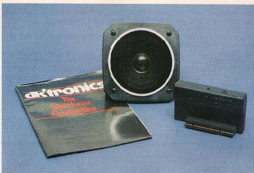
Lautsprecher und Klangmodul — die Hardware des Sound-Systems
