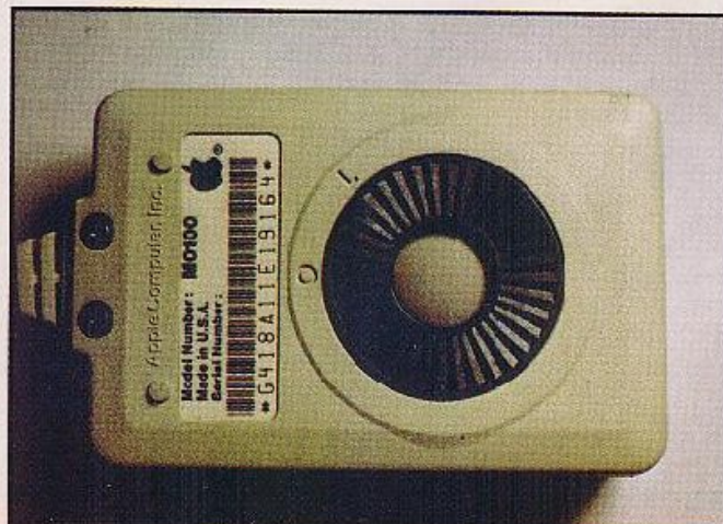
Bild 1. Die Maus (Unterseite) und ihr Bein. Die Rollkugel läßt sich ohne weiteres nach Drehen des Ringes herausnehmen.
