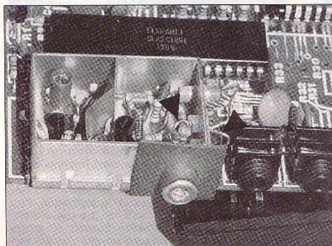
Die beiden Leitungen müssen getrennt werden. Anschließend wird das rechte Kabel von der Platine direkt mit der Antennenbuchse verbunden
