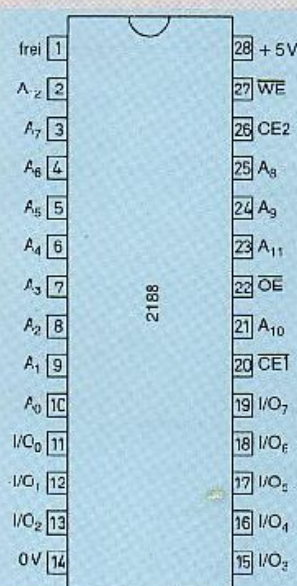
Anschlussschema des RAM-Typ 2188 mit 8192 x 8
