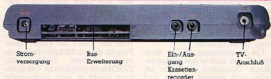
Buchsen-Beschaltung beim Spectrum
